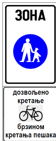
Слика 6.54. Препоручена сигнализација за обележавање пешачке зоне
