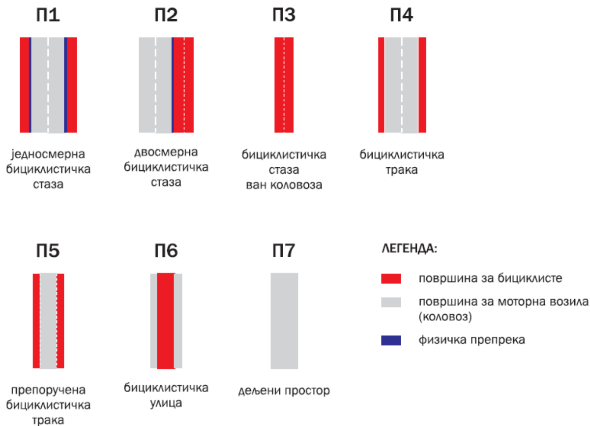
Слика 5.4. Основни попречни профили улица са простором за бициклисте
