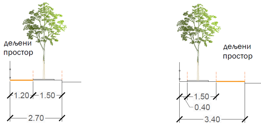
Слика 6.15. Масарикова: будући попречни профил ванколовозне површине на месту локалног сужења: варијанта 1 (лево) и варијанта 2 (десно)
